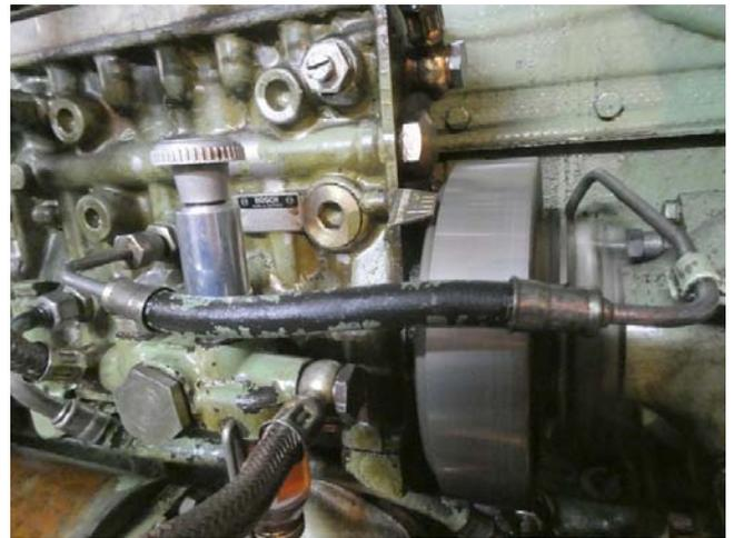
© GB 31.07.2021 undichte Schmierölleitung der Einspritzpumpe
