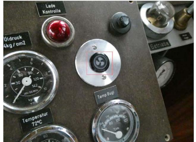
© GB 30.07.2021 Schalter für die Ventilatoren im Maschinenraum
